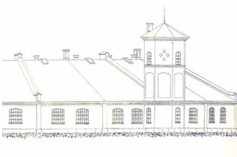
Osa veturitallin takapuolen julkisi- vua kahdeksankulmaisine vesitor- neineen. Tallin arkkitehtuurille ovat tyypillisiä laajat kattopinnat piip- puineen ja palo-osastojen kohdalla olevine korotuksineen. Kattojen harjoilla näkyvät ikkunat poistettiin 1916. KA
