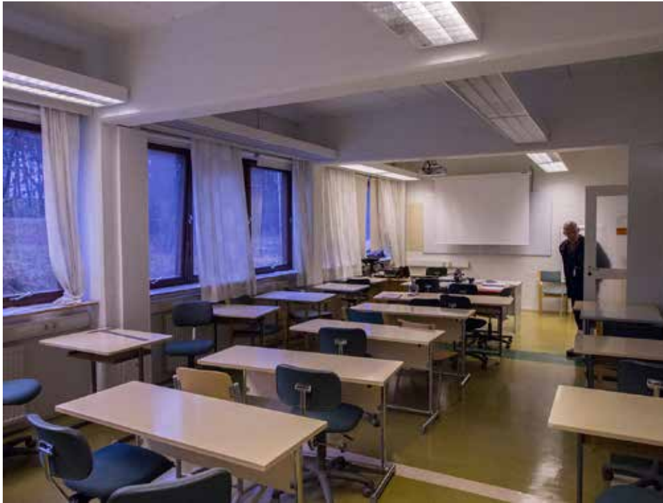
Yllä Luokahuone 365. Luokka on muodostettu yhdistämällä kolme toimistohuonetta. Rakennuksen pilari-palkkirunko mahdollistaa väli-seinien muuttamisen.
