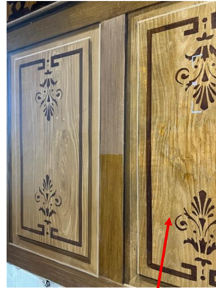
Kuva 7a. Kiillontasaustesti. Pystykehys öljytty puoleen väliin asti. Kuva otettu heti öljytessä, joten öljytty kohta on vielä märkä. Öljy selkeästi kirkastuttu ja syvensi sävyä, tulos pysyi samana öljyn kuivuttua.
