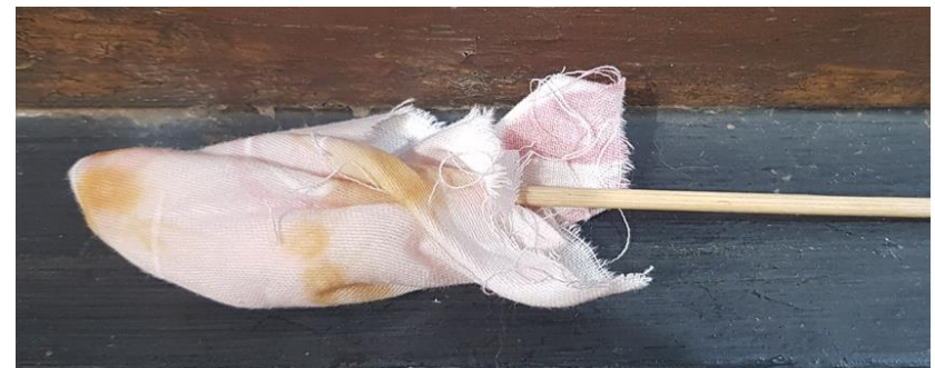
Pumpuli-puuvillatollo sellakkapinnan pyyhinnän jälkeen. Sellakka tarttui puuvillakankaaseen ja kangasta vaihdettiin pyyhinnän yhteydessä.
