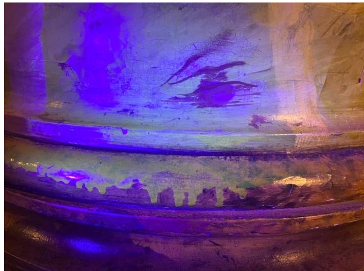
Kuva 1. UV-valo paljastaa pylvään varren vanhan retusoinnin tummana tahrana ja lakkakerrokset kellertävinä kerroksina. Pylväs 116-6eL.
