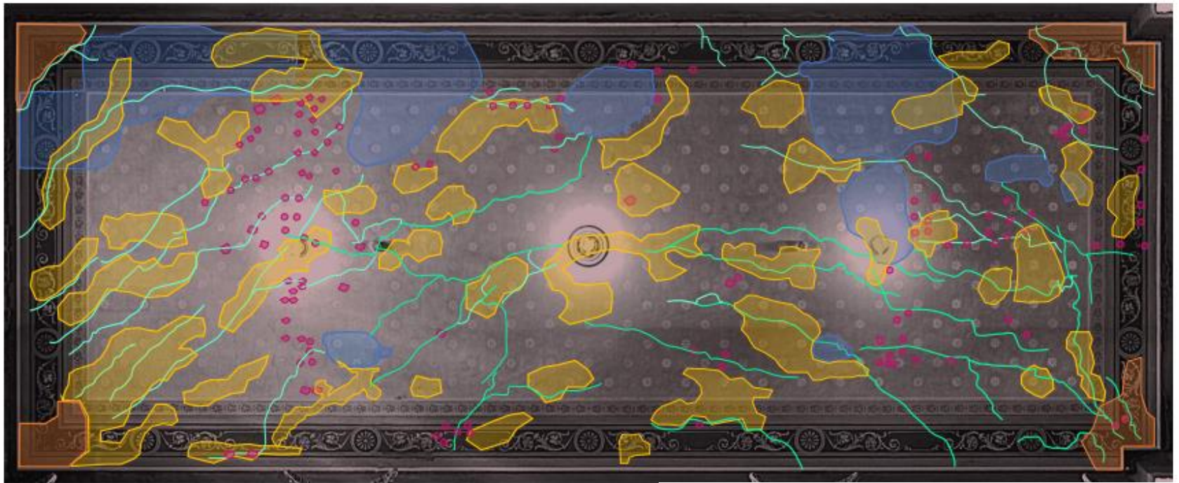
Kuva 4 Katon projektiokuvaan merkityt vaurioalueet
