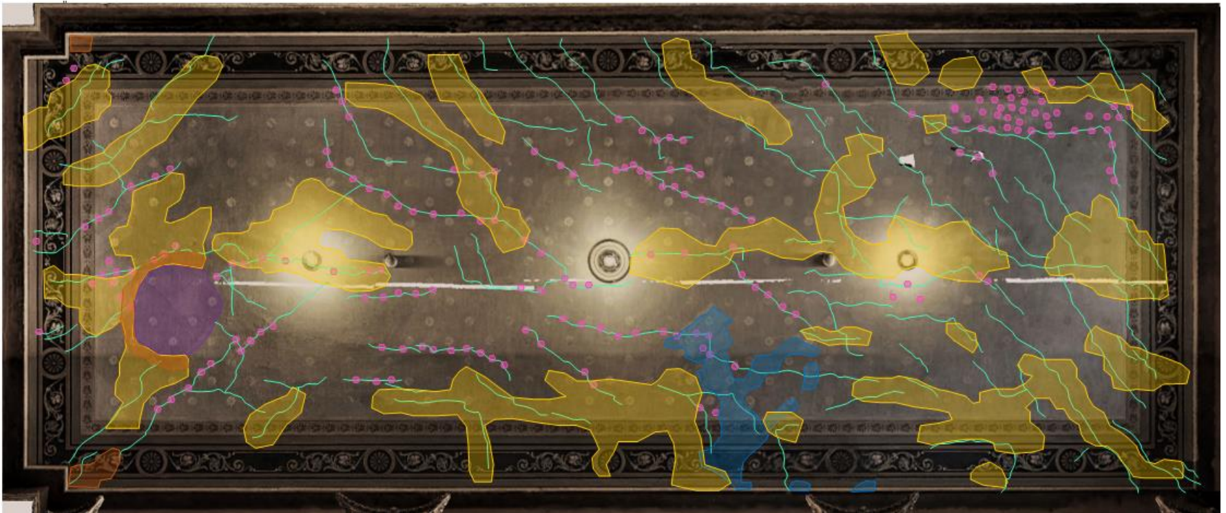
Kuva 24 Katon projektiokuvaan merkityt vaurioalueet
