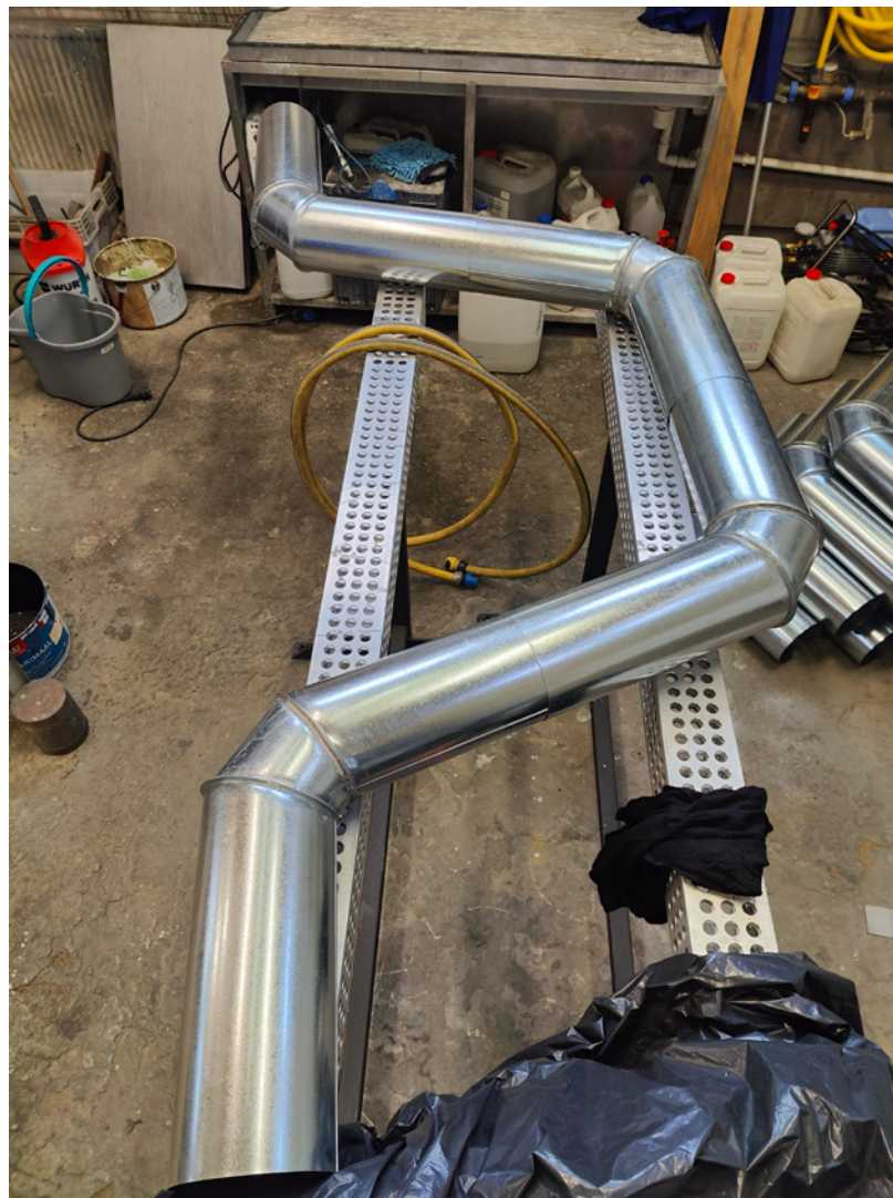
Syöksyjen uusia mutkaosia verstalla.
