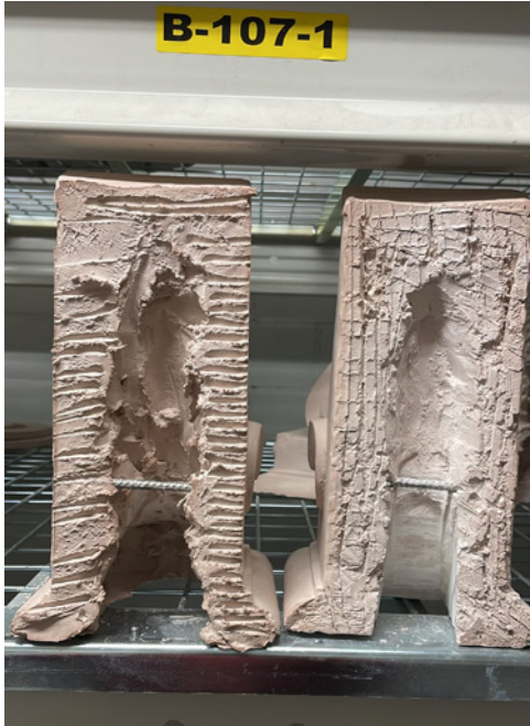
Koristeiden kiinityspintaan tehdään hyvät tartuntaurteet, jotta kiinnitys seinään on parempi.
