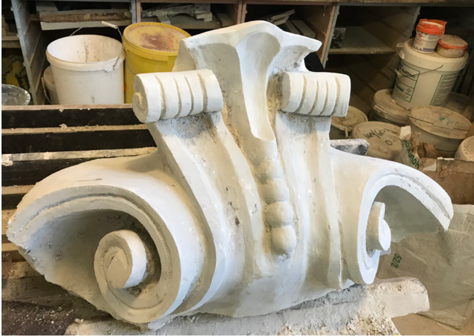
Koristeista valmistettiin ensin kipsistä valokset, joiden muodot terävöitettiin.
