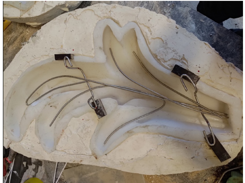
Valumuottiin asennettiin rauditus ennen massan levitystä.
