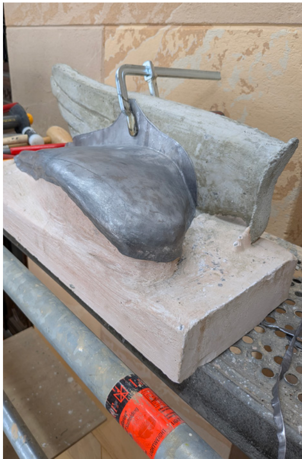
Siivekkäiden leijonien lyijypellin muotti, asennus ja maalattu koriste.
