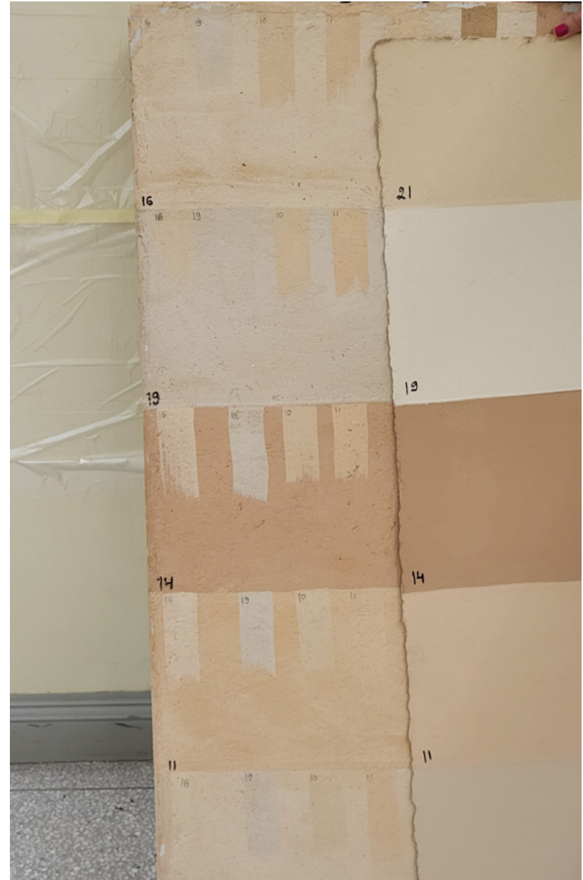
Mallilevyille tehty väripaletti kalkkimaaleista vasemmalla ja hydrosileistä oikealla. Kalkkimallissa näkyy myös miten värit toistuvat eri pohjasävyjen päällä.
