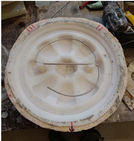
Valumuottiin asennettiin rauditus ennen massan levitystä.
