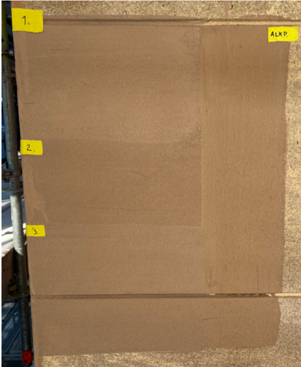
Maalierien sävyä kokeiltuna suoraan seinäpinnalle. Oikeassa reunassa alkuperäinen maalisävy.
