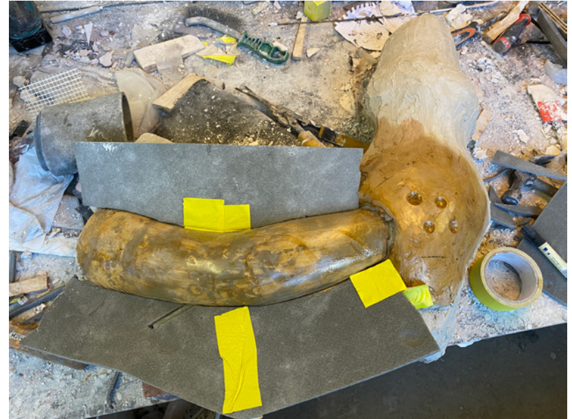
Tarkennettu kappale on käsitelty shellakalla silikonimuotitusta varten.
