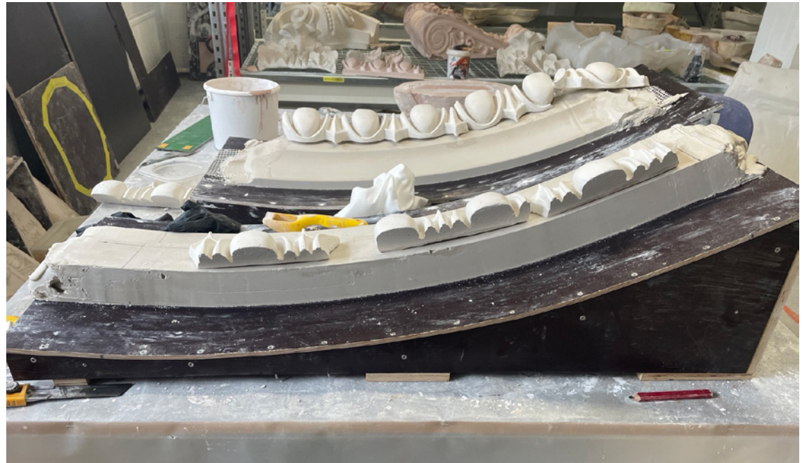
Kaarevien koristelintojen valuissa käytettiin vaneripohjia.
