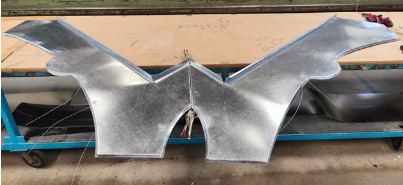
Nurkkakapiteelin uusi vesipelti verstaalla.
