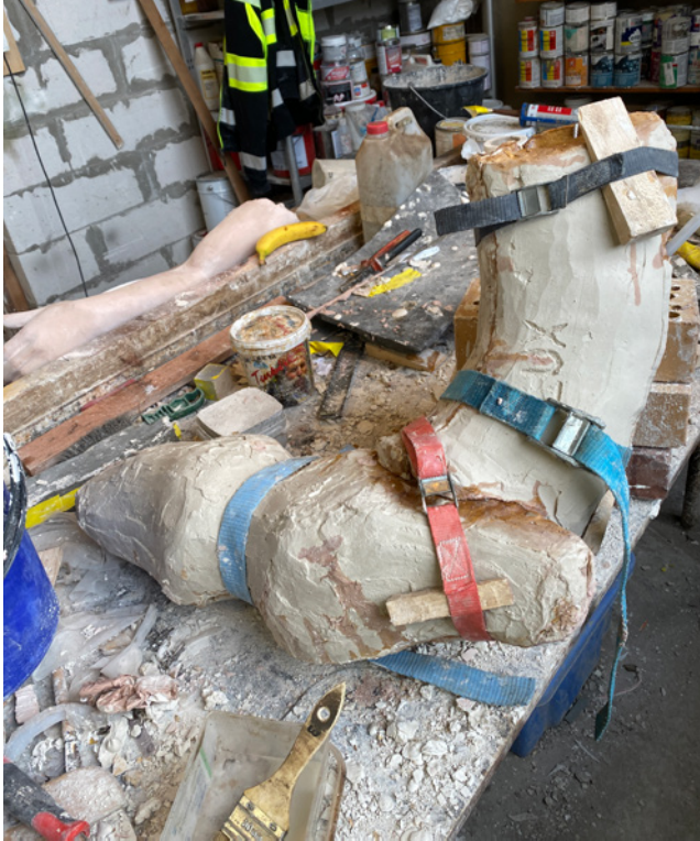
Valussa on varmistuttava, että kappa pysyy oikeassa muodossa.
