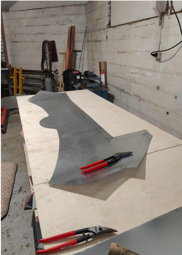
Kapiteelin vesipellin aihio verstaalla.
