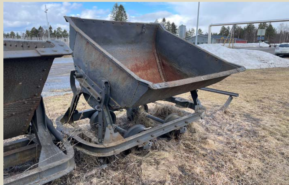
Kuuppavaunu mahdollisti kuljetettavan maa-aineksen kippaamisen sivuille. Vaunujen kyydissä voitiin kuljettaa myös vankeja kaukaisille työmaille.
