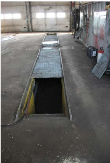
VASEMMALLA: Ajoneuvojen alapuolelta tapahtuvaan huoltoon varten tehty "rasvamonttu".
