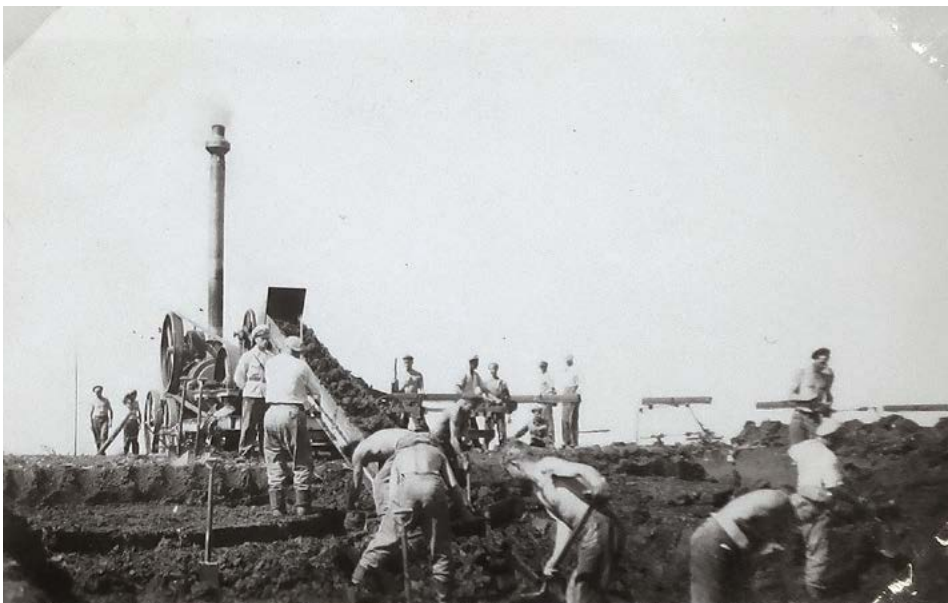
Polttoturpeen koneellista nostoa. Pelson koneet hankittiin Englannista 1940- ja 1950-lukujen vaihteessa. KUVA: Kansallisarkisto Ude 1.1 VAHO
