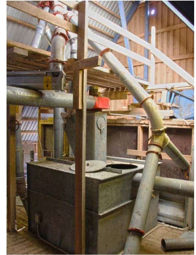
Kuivaamon ylin työskentelytaso. Kuivattu vilja nousee putkistoa pitkin ylös ulkopuoliseen viljasiloon.
