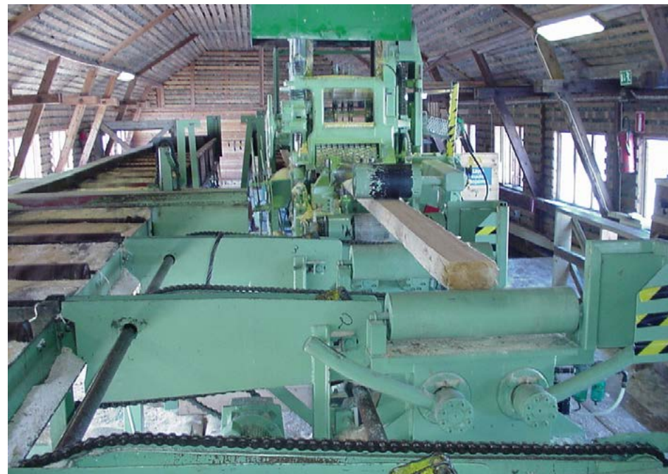
Laajimmillaan Pelson vankilan sahalaite kattoi koko tuotantoprosessin raakapuun käsittelystä jatkojalostetuksi höylätavaraksi. Kuvassa on automatisoitu raamisaha. KUVA: Pelson vankilan arkisto / Jouni Kauhasen kokoelma.
