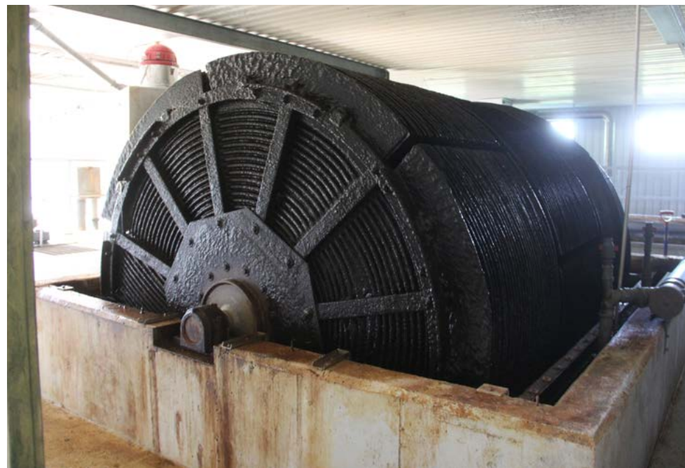
Suuri sylinteri pyörittää jätevettä ja erottaa kiintoaineen nesteistä.
