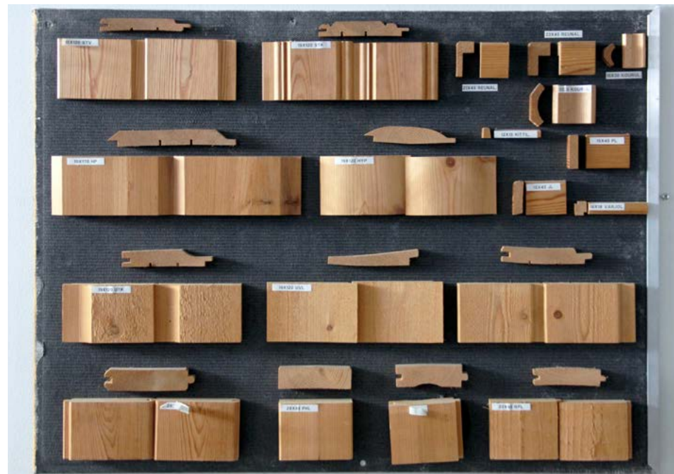
Pelson vankilan sahan tuotti pitkälle jalostettua puutavaraa, jota myytiin myös ulkopuolisille asiakkaille. Kuvassa vankilan listamallistoa esittelevä taulu puutyöhallin luokahuoneesta.
