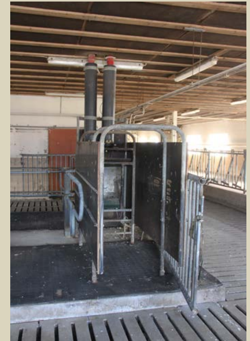
Ruokinta-automaatti eli "kioski". Rehu tuli putkea pitkin vinttikerroksen säiliöistä.
