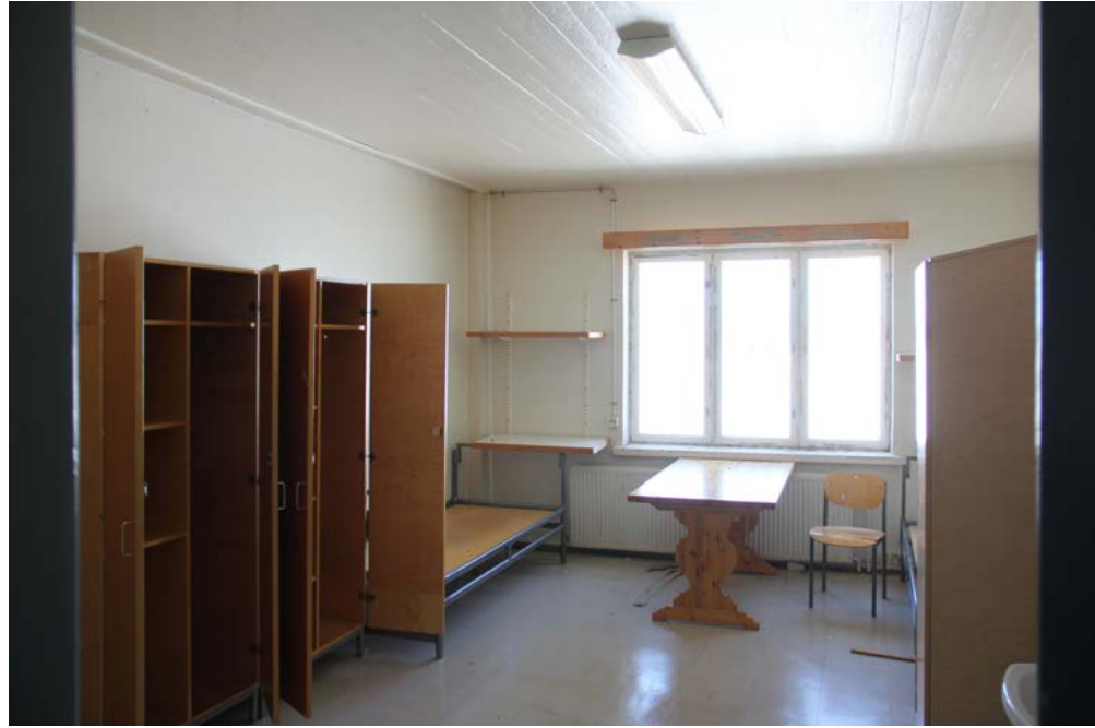
Kolmelle hengelle mitoitettu asuinselli tilan ovelta nähtynä. Vuoteista voitoin tarvittaessa muodostaa kerrossänkyjä. Vangin kaapin katto on tehty viistoksi estämään esineiden piilottaminen.
