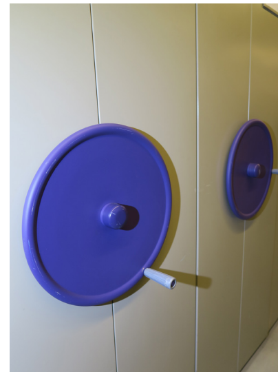
Makasiinihyllyt ovat käsikäyttöiset; pyöriöt kerroksen tunnustevärin mukaisesti violetit.
