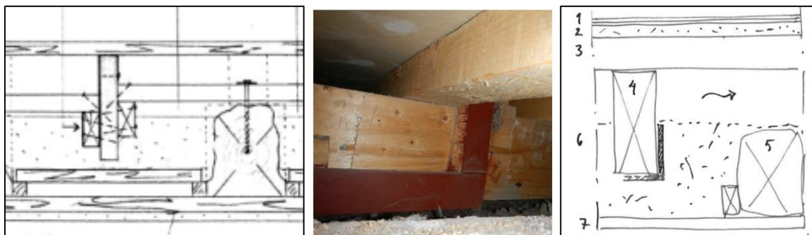
Kuvasarja: välipohjan korjaussuunnitelma rakennehistoriaselvityksessä, välipohjanäkymä kyseiseen kohtaan tehdystä rakenneavauksesta ja rakenneavauksen havaintojen dokumentointi. (Numerot oikeanpuoleisessa kuvassa: 1. linoleumimatto, 2. lastulevy, 3. uusi koolaus, 4. uusi palkki, 5. vanha palkki, 6. vanha täyttö 7. täyttöä kannattava vanha laudoitus)
