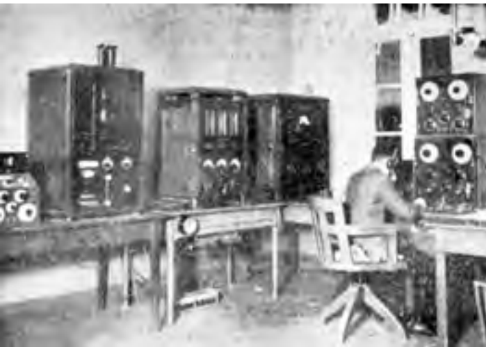
Yllä: Radioaseman sähkötyshuone, jossa vasemmal- la 15 kW:n putkilähetin ja oikealla vastaanotin. Julkaistu: US 7.2.1926.
