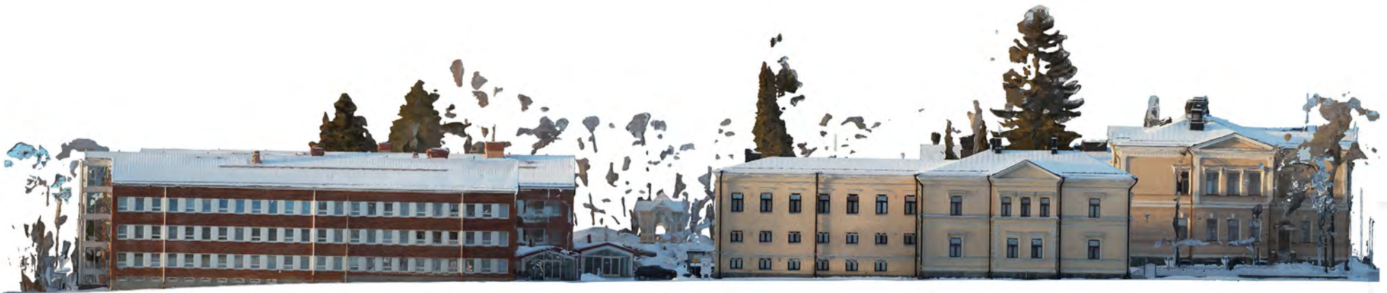
↑ Fotogrammetrinen projektio lääninhallituksen korttelin itäjulkisivusta.
