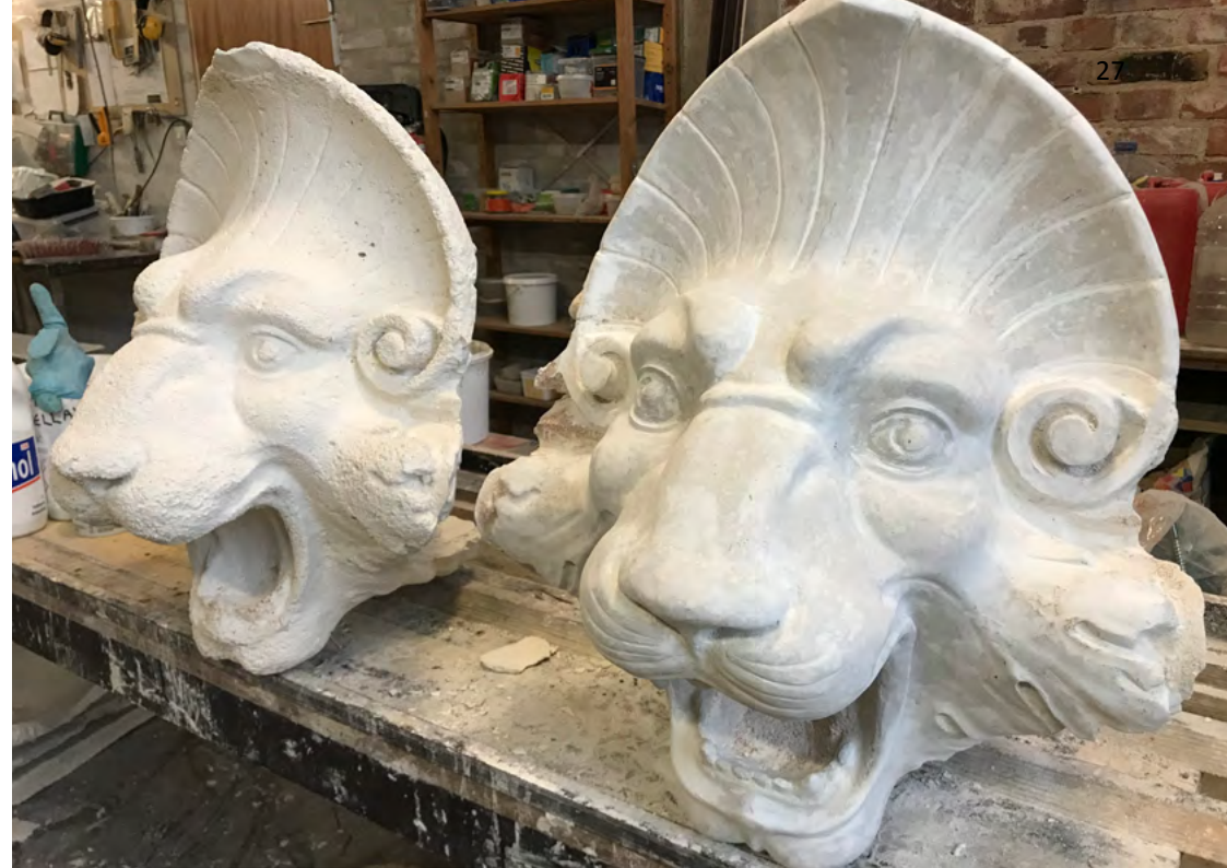
Kaikista koristeaiheita tehtiin muototutkielma, jotta säälellä alttiina oleva alkuperäinen muoto säilyisi mahdollisimman hyvin. Yllä yläleijonan karkea kipsivalos ja sen täydennetty rekonstruktio. Alla delfiinin pään alkuperäinen betonikappale, keskellä täydennetty kipsivalos ja oikealla uusi paikalleen sijoitettu betonivalos.
