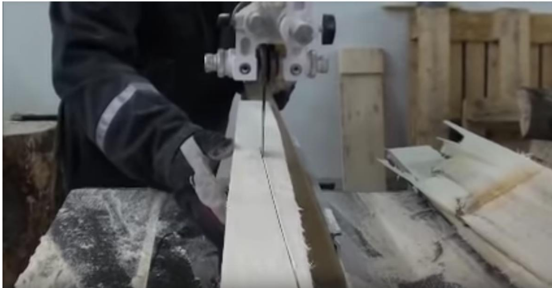
Kuva 8. Paanuaihiota sahataan kahteen osaan. Kuvankaappaus videosta. (Ahonen, 2013)
