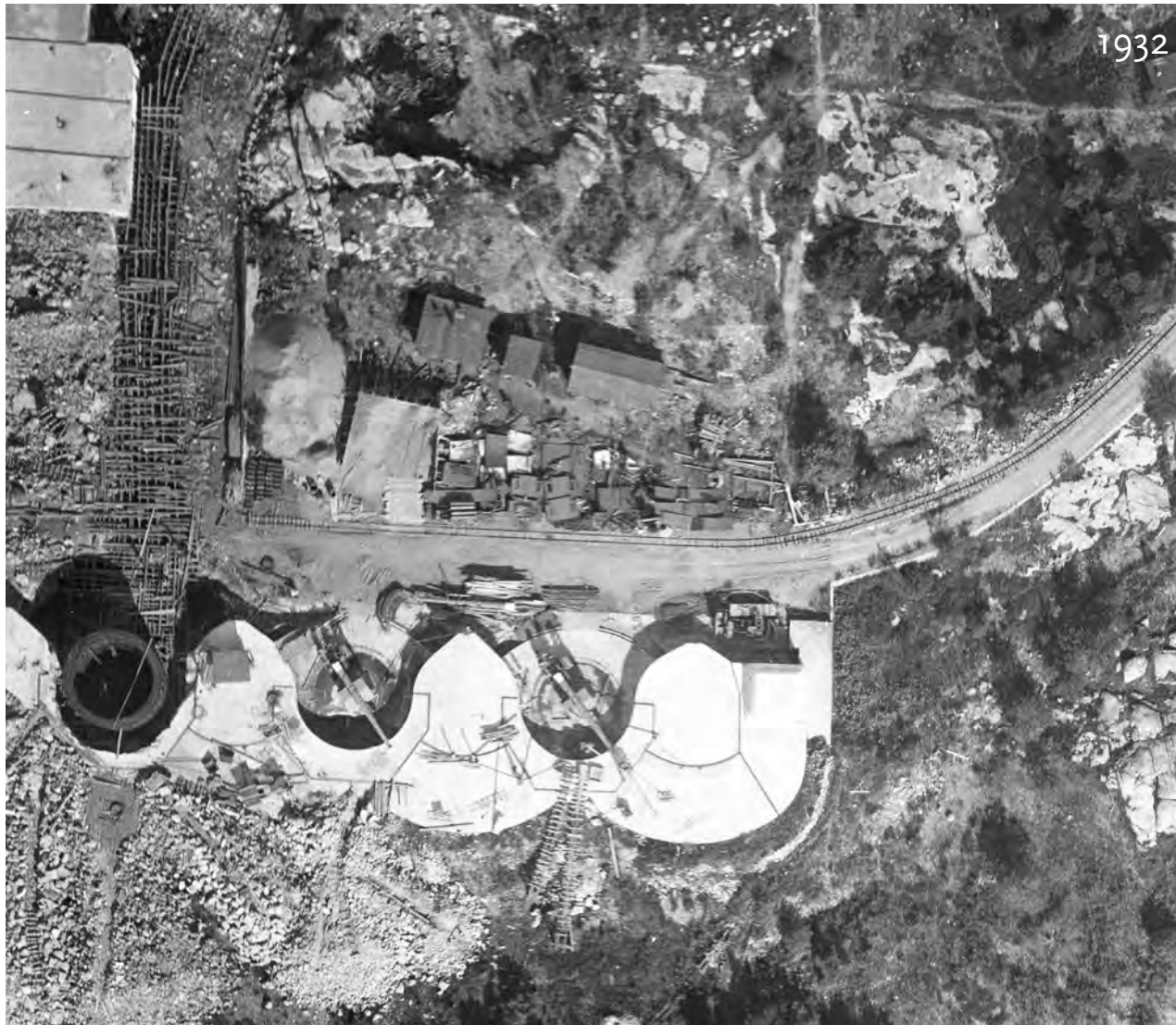
Vuoden 1932 ortoilmakuvassa näkyy kaksi 1910-luvulla asennettua kymmentuumaista Durlacher-tykkiä. Kuvan ulkopuolelle jää vielä kolmas. Yksi tykki on purettu ja sen paikalle rakennetaan 12-tuumaisen kaksoistykkin tornia, jonka lieriö on jo asennettu. Kuva (osa): Puolustusvoimat.
