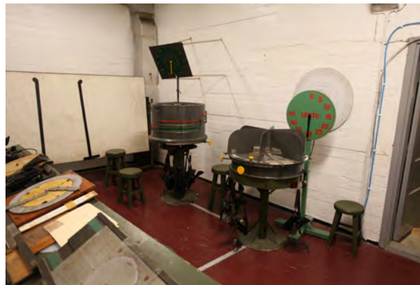
Keskiön laitteistolla on laskettu tykkien ampuma-arvoja eri laitteista ja mittauspisteistä saatujen tietojen perusteella.
