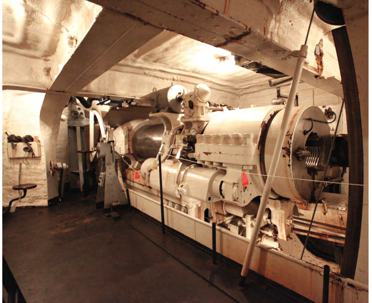
Kaksoistykkitornin ylin taso on niin kutsuttu tykkikerros. Syksyllä 2017 otetussa kuvassa näkyy toinen 12-tuumaisista Obuhov-tykeistä.
