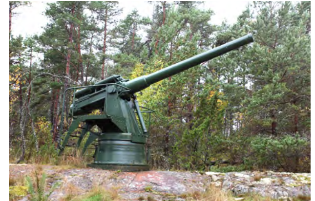
Kuva 15. Ranskalaisen insinöörin Gustav Canet'n tykistöjärjestelmään perustuva venäläisen Obuhov-tehtaan valmistama 120 mm:n 45 kaliiperin merikanuuna mallia Canet. Kuivasaaren 120/45 C on viimeksi ollut Rannikkotykistökoulun harjoitushallissa harjoitustykkinä.
