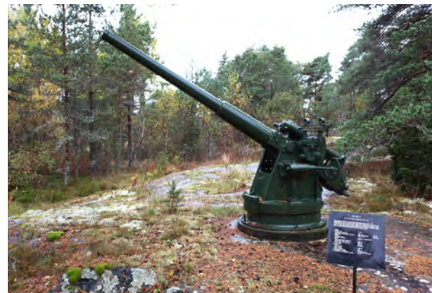
Kuva 16. Canet-mallinen 75 mm:n 50 kaliiperin merikanuuna, jota käytettiin lähipuolustukseen, laivatykkinä ja rajoitetusti ilmatorjuntaan.
