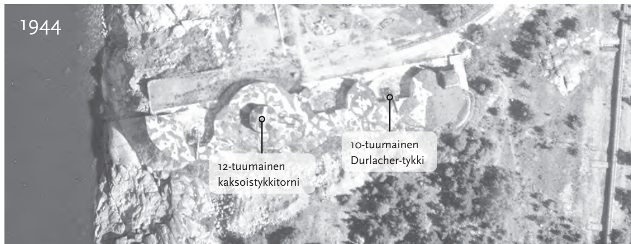
28. heinäkuuta 1944 otetussa ilmakuvassa näkyy, että kasemattien katot naamiomaalattiin, jotteivät vihollisen lentokoneet olisi havainneet rakennelmia. Kuva (osa): Puolustusvoimat.
