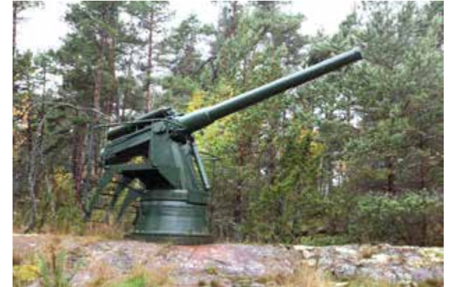
Kuva 15. Ranskalaisen insinöörin Gustav Canet'n tykistöjärjestelmään perustuva venäläisen Obuhov-tehtaan valmistama 120 mm:n 45 kaliiperin merikanuuna mallia Canet. Kuivasaaren 120/45 C on viimeksi ollut Rannikkotykistöskoulun harjoitushallissa harjoitustykinä.
