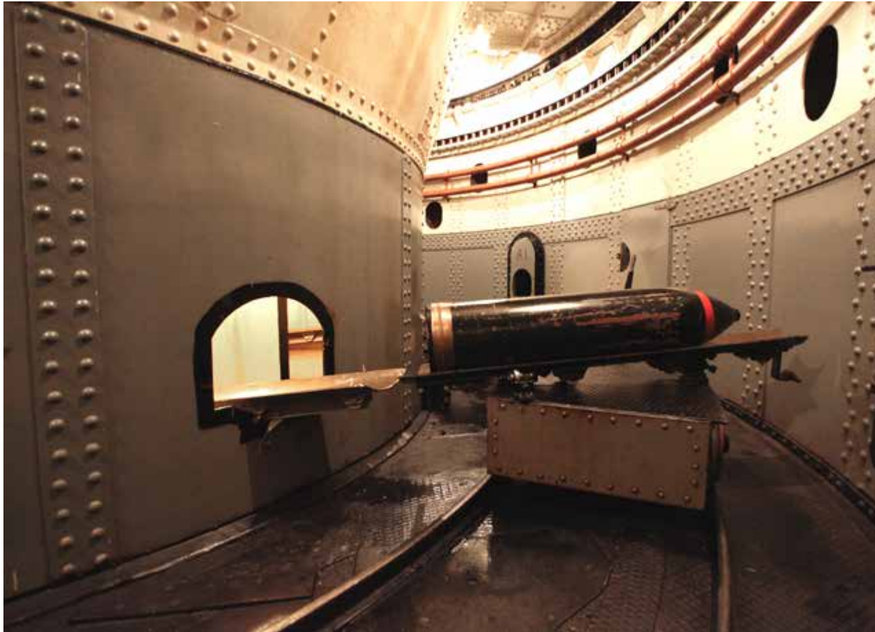
Kaksoistykkitornin sisätily syksyllä 2017. 12-tuumaisen Obuhovin ammuksat nostetaan sähköistetyllä hissillä alimmasta kerroksesta ylimpään tykkikerrokseen.
