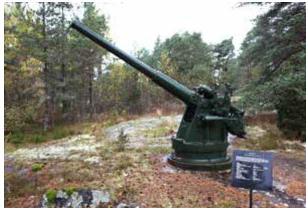
Kuva 16. Canet-mallinen 75 mm:n 50 kaliiperin merikanuuna, jota käytettiin lähipuolustukseen, laivatykinä ja rajoitetusti ilmatorjuntaan.
