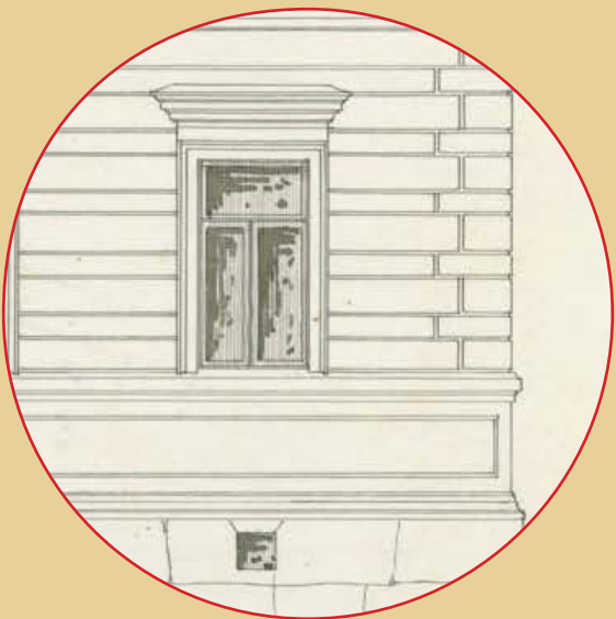
60. Julkisivujen käsittely noudatti päärakennuksen tyyliä. Poikkeuksen muodostivat ikkunat, joiden ympärille talousrakennuksessa tehtiin valkoinen rappauskehys ja yläpuolelle kerroksellinen lista. KUVA: Kansallisarkisto (osasuurennos)
