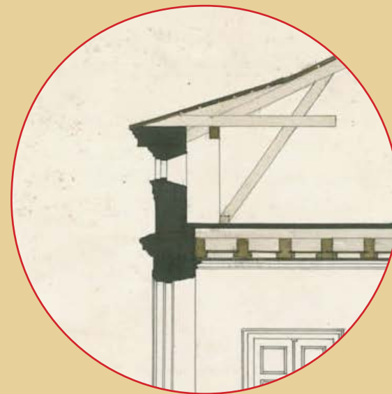
61. Tuulettuva ullakkotila tehtiin korkeaksi ja se varustettiin luonnonvaloa antavilla haukkaikkunoilla. Tilan käytävyyttä paransivat myös ruotsalaiset kattotuolit, joiden jalusorsi sijoitettiin lähelle ulkoseinää. Yläpohjan eristeenä oli hiekkasammaltäyttö, jonka päällä on tiilistä ladottu palopermanto. KUVA: Kansallisarkisto (osasuurennos)
