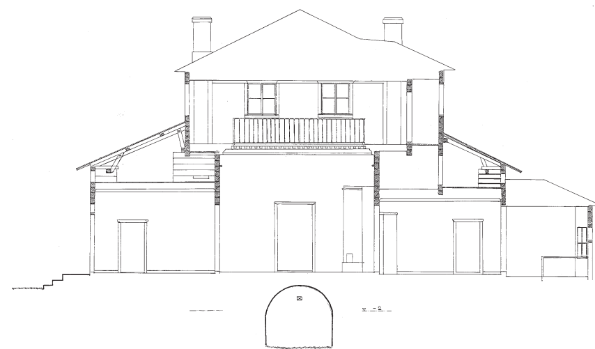
Ylipytingin poikkileikkaus. Kuva: MV pääarkisto, 505.3.10/11 / S. Saikkonen / E. Jama / E. Tohka / V. Laine, 1968/1967.
