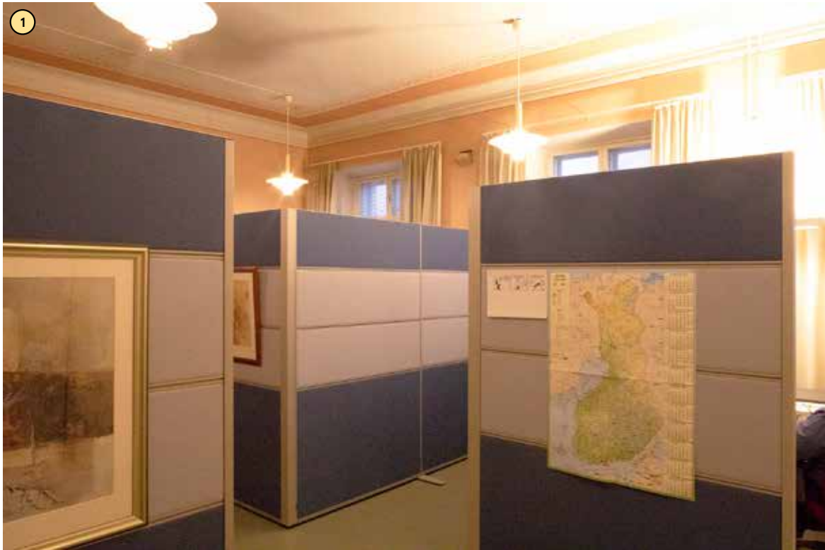
Tilojen restaurointitavoitteet ovat olleet paikoittain ristiriidassa tilojen nykyisen käyttötarkoituksen kanssa. Ongelmaa on pyritty ratkaisemaan esimerkiksi siirrettävin konttoriseinin.
