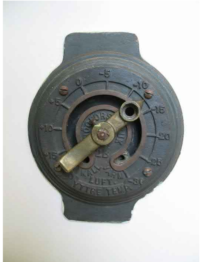
Alkuperäisen lämmitysjärjestelmän säilynyt säätölaite.
