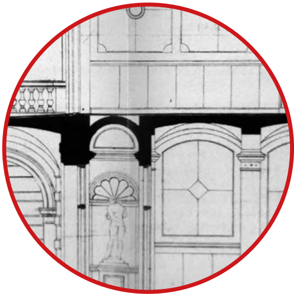
73. Kiseleffin leikkauspiirros vuodelta 1882 kuvaa holvien kannattamaa välipohjaa vesitubulissa. Kuva: Museoviraston suojelukohteiden kokoelma.
