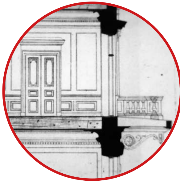
74. Maaherran huoneen välipohjassa oli puinen ansarakenne. Pitkän jännevälin vuoksi lattiaa jouduttiin vahvistamaan vuonna 1979. Kuva: Museoviraston suojelukohteiden kokoelma.
