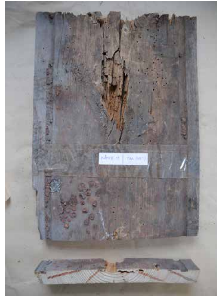
Tyypittelyssä otettiin huomioon laudan sahaus/höyläys, paksuus, leveys sekä vesiurien etäisyys reunasta muoto ja koko.
