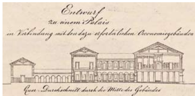
C. L. Engelin suunnittelemat kattorakenteet
