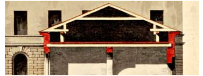
C. L. Engelin laatima leikkauspiirros Senaatin linnasta. Vasemmalla länsisiipi ja yllä itäsiipi, joka on sittemmin kulmapaviljonkeja lukuun ottamatta purettu. KA.
