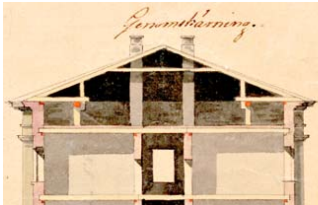
C. L. Engelin suunnittelemat kattorakenteet
