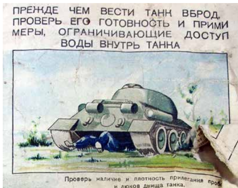
Osa Porkkalan alueelta 1956 löytyneestä opetustaulusta, jossa ohjeistetaan toimenpiteet panssarivaunujen vesistön ylitystä varten. ”Ennen kuin tankilla lähdetään eteenpäin, on ryhdyttävä toimenpiteisiin veden tulon estämiseksi tankin sisään.” KA
