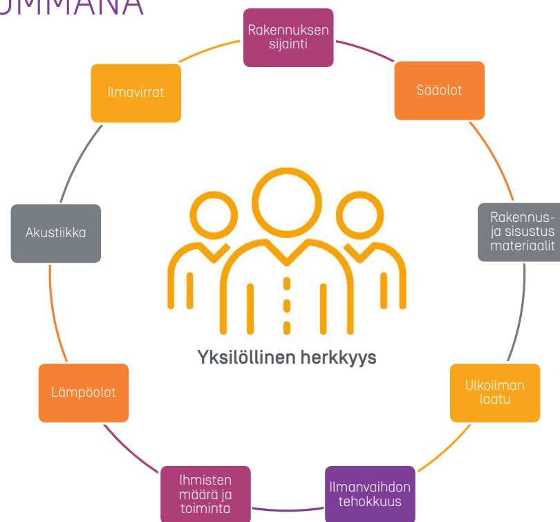
KUVA 1. SISÄILMAKOKEMUKSEEN VAIKUTTAVAT TEKIJÄT.
