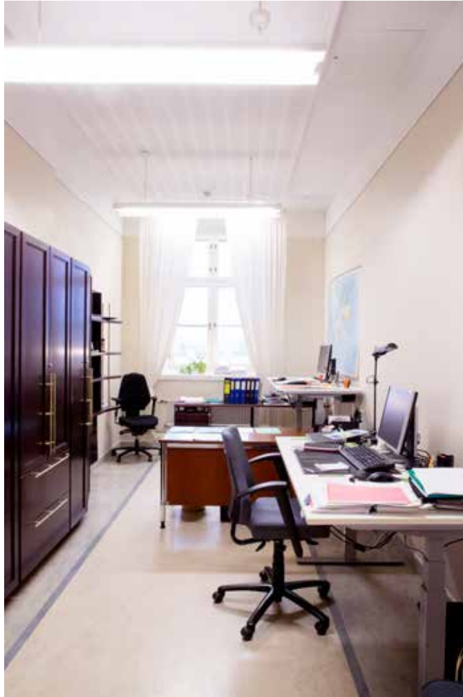
Toimistohuoneissa on joko suora maalattu kattopinta tai tähän pintaan on kiinnitetty uritettuja akustolevyjä. Lattia on linoleum-mattoa. Kuva tyypillisestä toimistohuoneesta rakennuksessa A.
