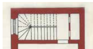
Pihasiiven eteläpäädyn keittiöporras on kapea betoniporras. Portaassa on pölytysparvekkeita.
