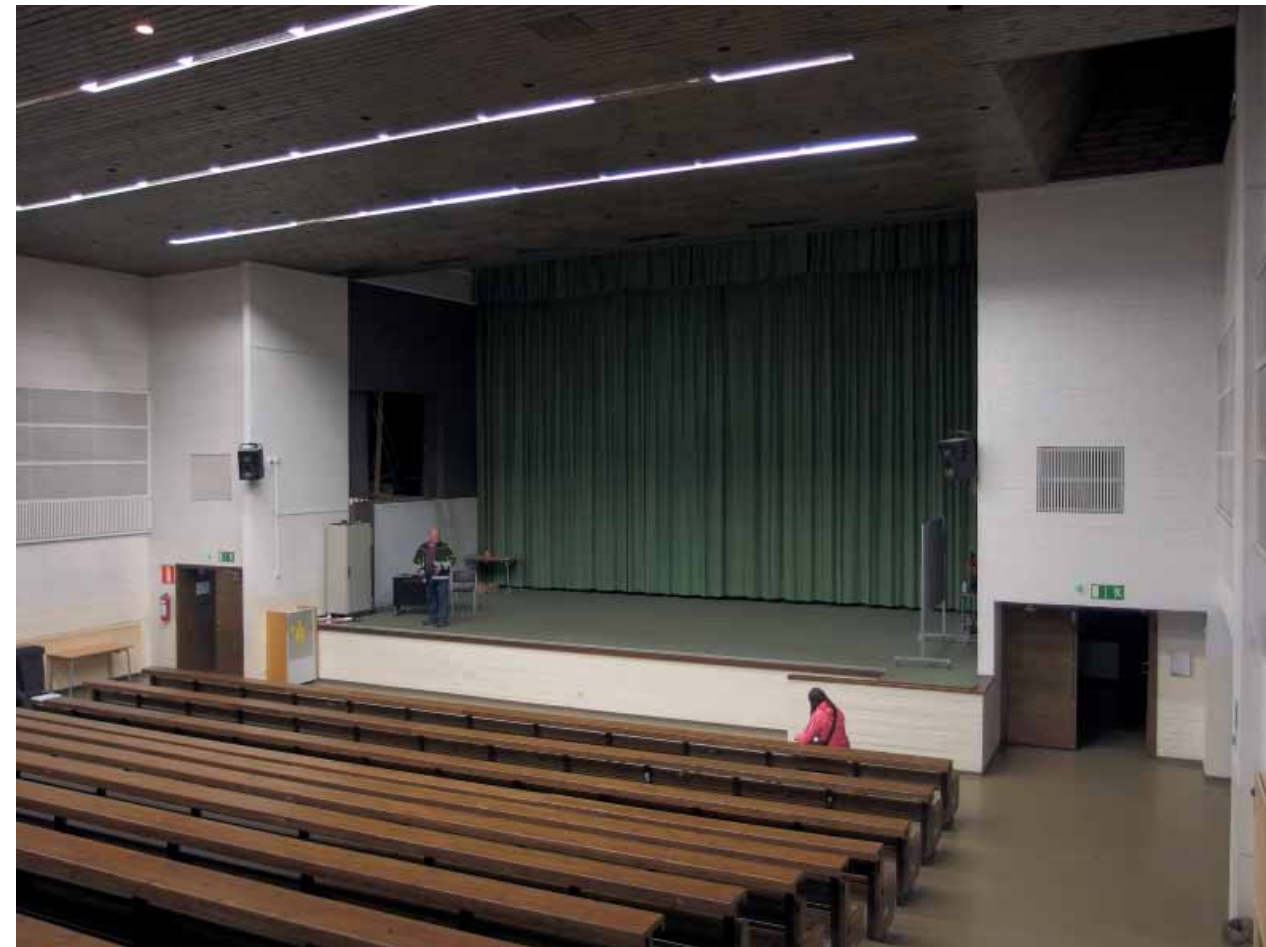
Elokuvaluokaksi nimitetyn rakennuksen sali on monikäyttöinen. Salissa on suuri näyttämö ja salia voidaan käyttää myös auditoriona. Salin seinillä on rimoitusten suojaamat akustoivat verhousket.
