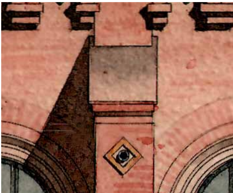
Esimerkki kontreforin yläpään muodonannosta Dalströmin suunnitelmassa ja alla nykytilanne.
