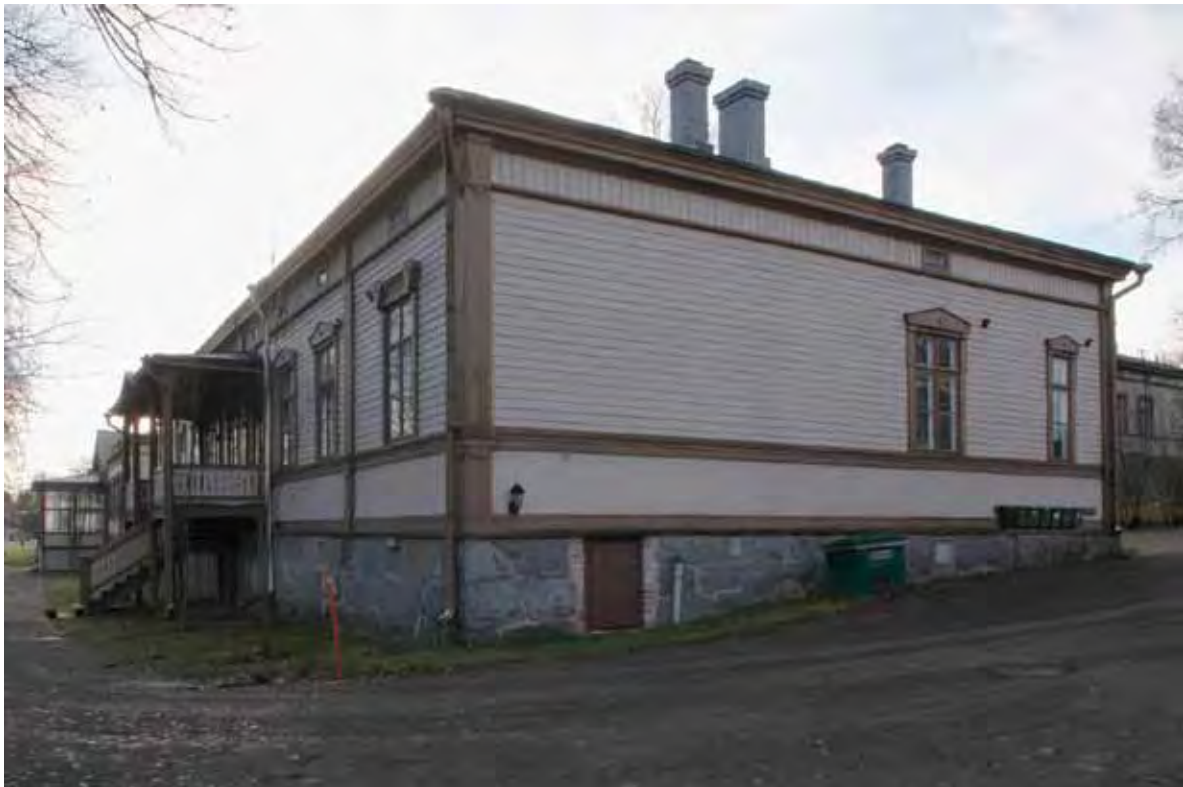
Eureninkadun puoleinen rakennuksen 4 sisäänkäynti ja pohjoispäädyn julkisivu. Vuorilaudat, ikkunat ja räystäät on maalattu ruskeiksi, muuta seinäpintaa tummemmiksi.
