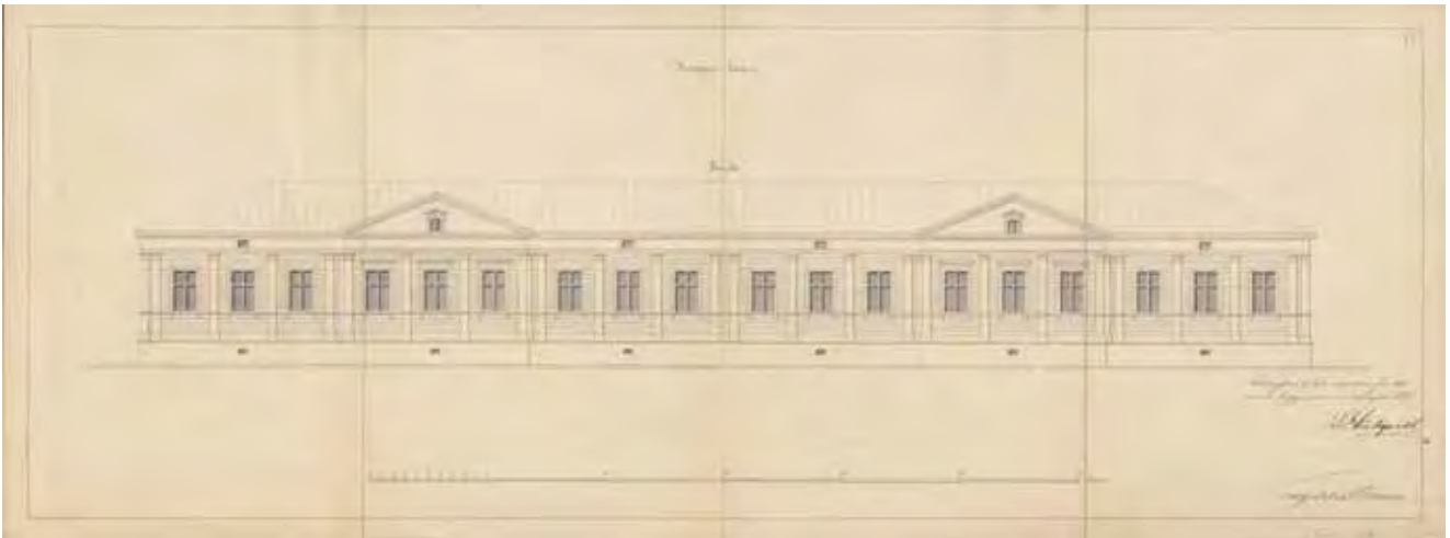
Komppaniakasarmien julkisivu etelään. Tyypipiirustuksen on suunnitellut Yleisten rakennusten ylihallitukselle arkkitehti August Boman elokuussa 1879. Piirustuksen on allekirjoittanut myöskin L. Lindqvist. Suomen kasarmien rakennus II on rakennettu tämän tyypipiirustuksen mukaan. KA.
