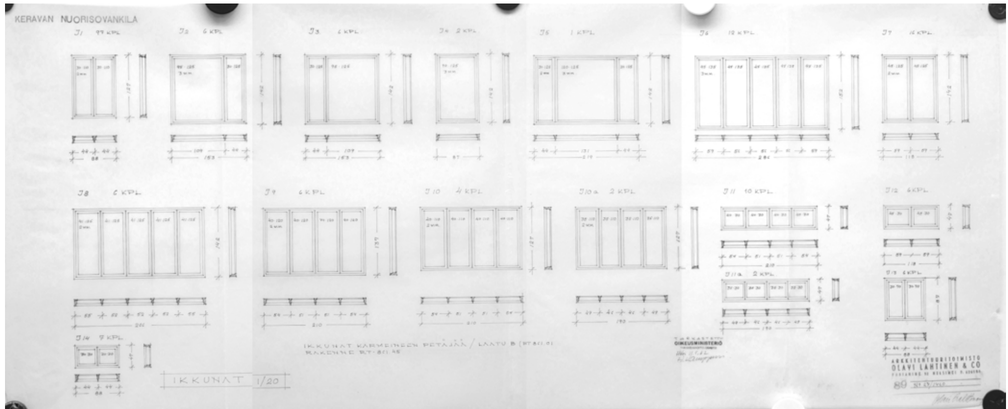
Arkitehtuuritoimisto Olavi Lahtinen & Co:n suunnitelma poikaosaston ikkunatyy- peistä. Vanhivistettu Oikeusministeriössä 11.1.1962. KA Vaho II la 1012, 1015, 1016.
