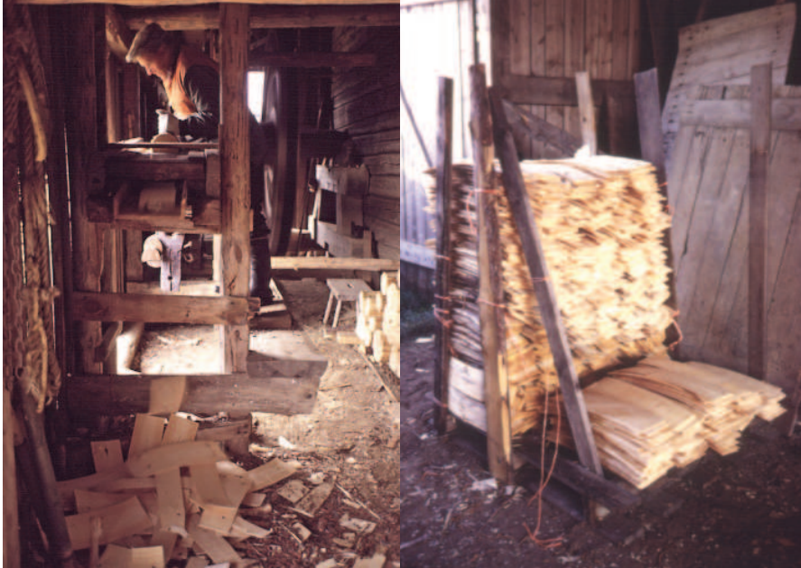
Kuvat 207 ja 208. Päreiden höyläystä Lamminahon pärehöylällä ja valmiita päreitä pinottuna.
