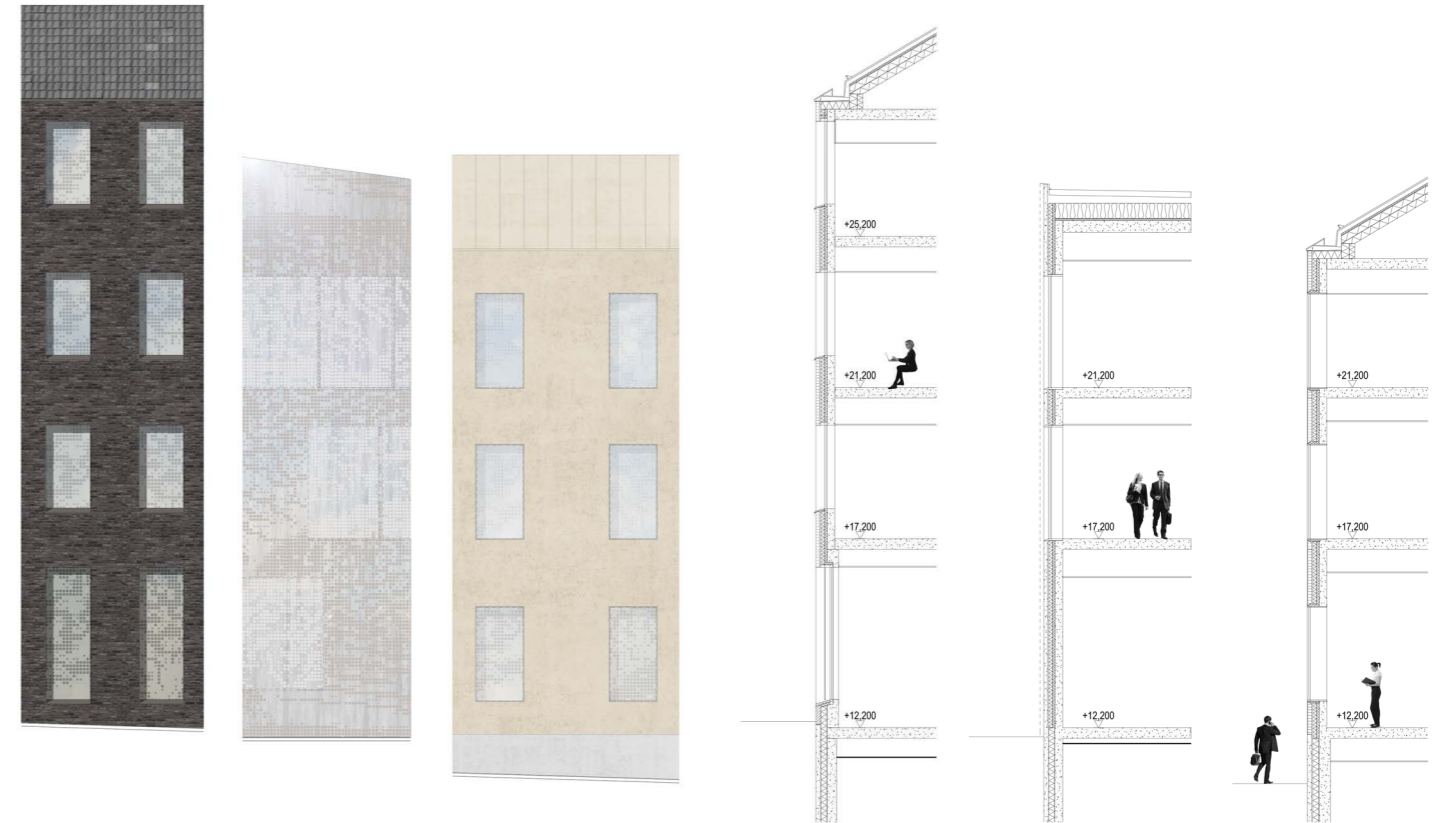
JULKISIVUOTE JA -LEIKKAUS TIILIJULKISIVUN, METALLIJULKISIVUN JA RAPATUN JULKISIVUN KOHDALTA 1/100
